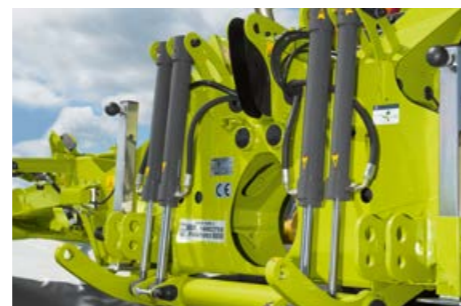
Vérins de suspension et de relevage montés de série pour l'ACTIVE FLOAT afin de ménager la couche végétale
