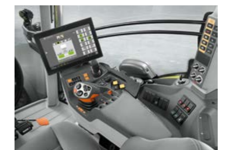
Commande par présélection du CONTOUR possible sur terminal compatible ISOBUS si le tracteur en est équipé
