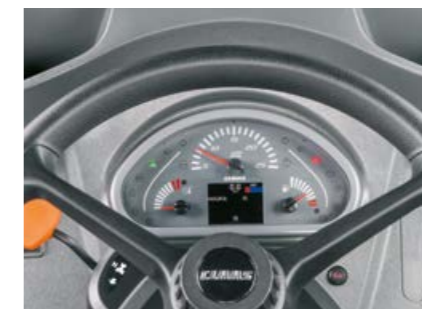
Toutes les informations essentielles sont visibles en un coup d'œil sur le tableau de bord parfaitement agencé. L'afficheur numérique affiche les paramètres de fonctionnement supplémentaires.
