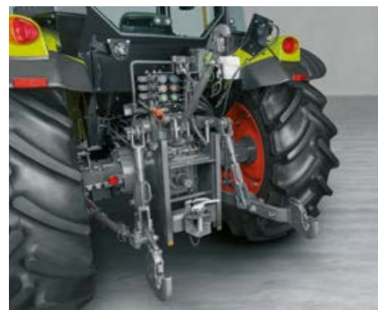
Avec une capacité de relevage maximale de 3,2 t, l'ELIOS est idéal au quotidien.
