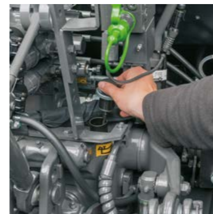
Le contrôle du niveau d'huile de transmission et d'huile hydraulique s'effectue facilement à l'arrière.
