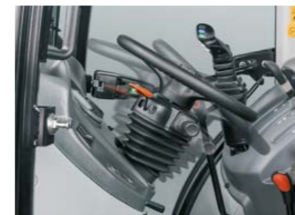
La colonne de direction réglable en hauteur et en inclinaison s'adapte à la position du conducteur.
