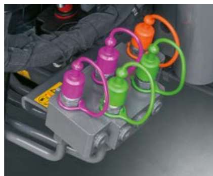
Jusqu'à quatre coupleurs hydrauliques et un retour libre sont disponibles à l'avant droit de la cabine.
