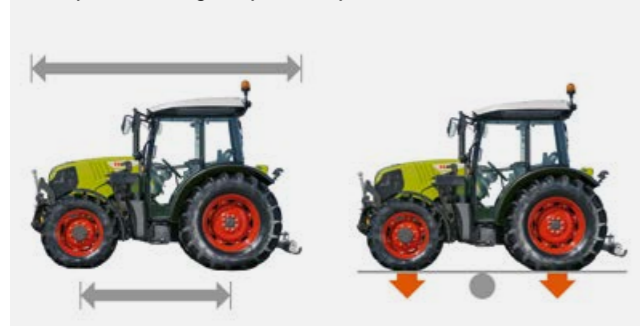
Empattement long et répartition optimale des masses
