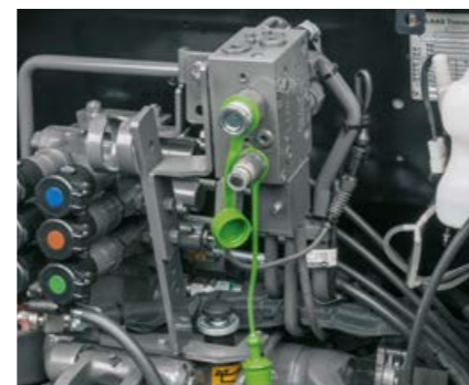
Le freinage hydraulique de remorque double ligne assure une grande polyvalence au transport.
